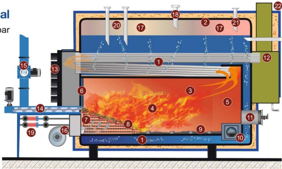
Klassischer 3-Zug-Kessel mit direkt in das Flammrohr integriertem Biomasse-Verbrennungsrost ist schnell regelbar, da das Prinzip der „kalten Brennkammer“ keine Ausmauerung erforderlich macht.
